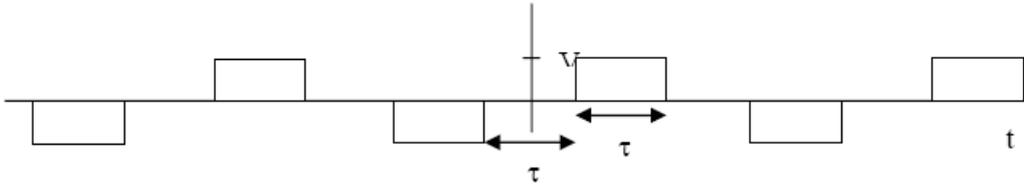
Para obtener los coeficientes de la serie de Fourier primero se necesita saber el periodo con el cual se repite el pulso, gráficamente se puede observar que la señal se repite con un periodo igual a  $4\tau \Rightarrow T = 4\tau$ .
